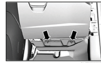
Fig. 1 Retrait du panneau d'isolation. Ford Focus 2012-13
