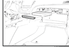
Fig. 11 Retiro del compartimento del filtro de aire del acompañante. Cadillac XTS 2013.
